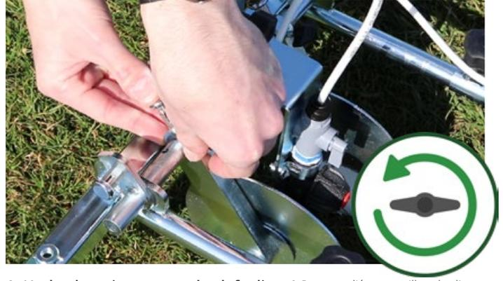
1. Undo the wingnut on the left disc. / Desserrez l'écrou papillon du disque de gauche. / Die Flügelmutter an der linken Scheibe lösen. / Draai de vleugelmoer op de linker schijf los. / Fjern vingemøtrik på venstre skive. / Lossa vingmuttern på den vänstra skivan. / Irrota vasemman leyn siipimutteri. /
