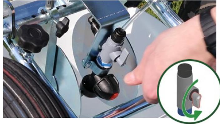
**8. Turn the valve into the downward position.** / Tournez la vanne vers le bas. / Drehen Sie nun den Ventilhebel um 180°, mit dem Uhrzeigersinn, in die vertikale Stellung nach unten bei weiterhin laufender Pumpe. / Zet het grijze ventiel (vooraan) in de positie naar beneden. / Drej ventilen over dysehovedet til lodret nedre position. / Vrid ventilen till nedåtgående läge. / Käännä venttiili takaisin alaspäin. /
