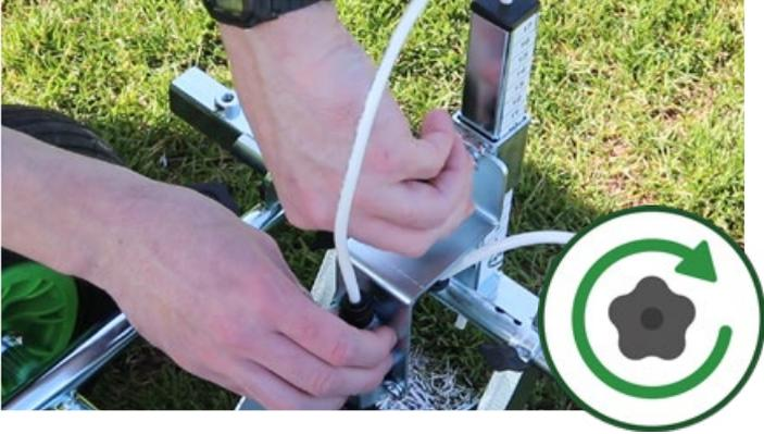
**5. Retighten the small handwheel.** / Resserrez la petite manivelle. / Das kleine Handrad wieder anziehen. / Draai het kleine handwiel weer vast. / Spænd det lille håndhjul. / Dra åt den lilla ratten igen. / Kiristä pieni sormiruuvi uudelleen. /
