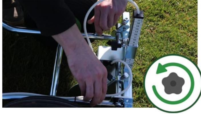
**2. Undo both handwheels on the front-end section. /** Desserrez les deux manivelles de l'extrémité avant. / Beide Handräder im vorderen Bereich lösen. / Draai beide handwielen aan de voorkant los. / Fjern begge håndhjul på forreste del. / Ta loss båda rattarna på den främre sektionen. / Irrota molemmat sormiruuvit etupäästä. /
