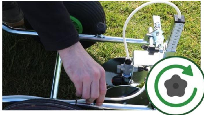
**4. Retighten both of the handwheels. /** Resserrez les deux manivelles. / Beide Handräder wieder anziehen. / Draai beide handwielen weer vast. / Spænd begge håndhjul fast igen. / Dra åt rattarna igen. / Kiristä molemmat sormiruuvit uudelleen. /
