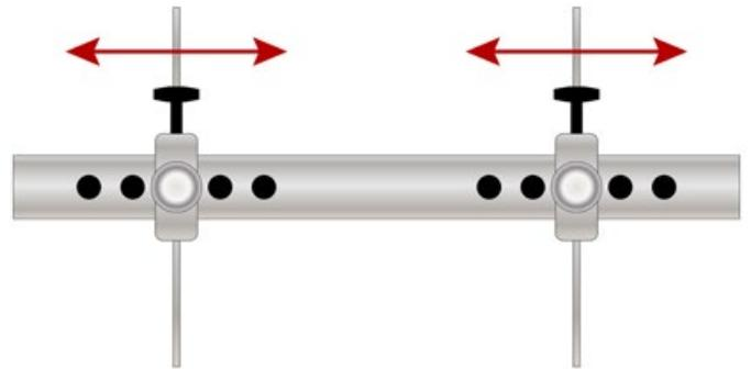
3. Slide the disc across to the required pre-drilled hole. / Faites glisser le disque jusqu'au trou prépercé requis. / Die Scheibe bis zum erforderlichen Bohrloch schieben. / Schuif de schijf naar het gewenste voorgeboorde gat. / Før skiven på tværs af det ønskede forborede hul. / Dra skivan åt sidan till önskat förborrat hål. / Liu'uta levyä tarvittavaan valmiiksi porattuun reikään. /
