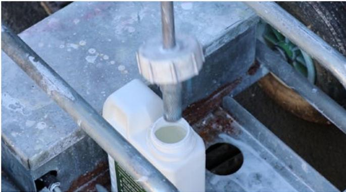
**3. Place the probe in a drum of clean water or the water tank.** / Placez la sonde dans un bidon d'eau propre ou dans le réservoir d'eau. / Messfühler in einen Behälter mit sauberem Wasser oder in den Wassertank tauchen. / Plaats de sonde in een bus met schoon water of in het waterreservoir. / Sæt sonden i en tromle med rent vand eller vandbeholder. / Lägg proppen i en trumma med rent vatten eller i vattentanken. / Aseta anturi purkkiin puhdasta vettä tai vesisäiliöön. /
