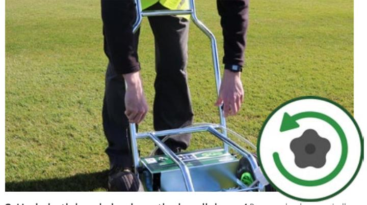
**2. Undo both handwheels on the handlebars.** / Desserrez les deux manivelles du guidon. / Beide Handräder an der Lenkstange lösen. / Draai beide handwielen aan het stuur los. / Fjern begge håndhjul på styrestængerne. / Ta loss båda rattarna på handtagen. / Irrota molemmat sormiruuvit ohjaustangosta. /
