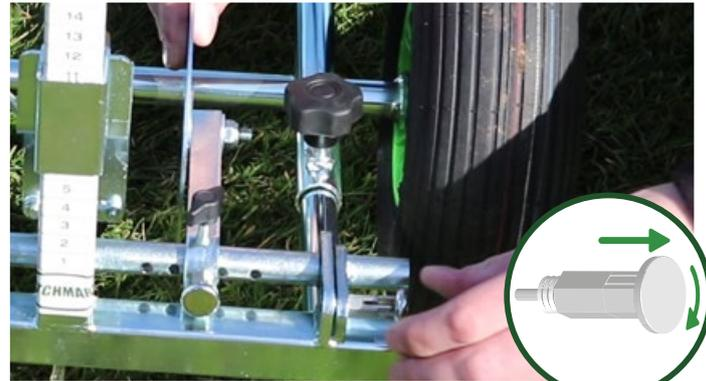
**4. Pull out the index plunger and drop the discs down.** / Retirez le piston d'indexation et faites tomber les disques vers le bas. / Indexbolzen herausziehen und lassen Sie die Scheiben nach unten fallen. / Trek de indexplunjer eruit en laat de schijven vallen. / Træk stempel ud og slip diske ned. / Dra ut indexkolven och släpp ner skivorna. / Vedä jousitettu metallikiinnike ulos ja pudota levyjä alas. /
