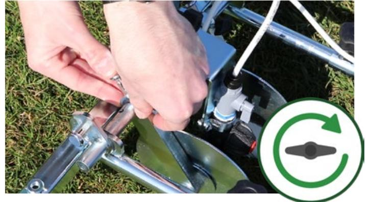
**5. Retighten the wingnut.** / Resserrez l'écrou papillon. / Die Flügelmutter wieder anziehen. / Draai de vleugelmoer weer vast. / Spænd vingemøtrikken igen. / Dra åt vingmuttern igen. / Kiristä siipimutteri uudelleen. /
