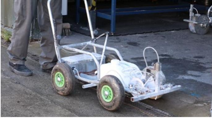
**1. Position the marker over a drain or a bucket.** / Placez le marqueur sur un drain ou un seau. / Das Markierungsgerät über einen Ablassbehälter oder Eimer stellen. / Plaats de lijnmarkeerder boven een afvoer of bak. / Placer markøren over afløb eller spand. / Ställ markeraren över ett tråg eller en hink. / Aseta laite lattiakaivon tai ämpäriin päälle. /
