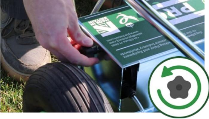
**5. Undo small handwheels and remove rear cover.** / Desserrer les petites manivelles et enlever le capot arrière. / Lösen Sie die 2 Knaufschräuben des Batteriedeckels am Heck des Wagens und nehmen Sie den Deckel ab. / Draai de kleine zwarte vijzen los en verwijder het beschermingsdeksel. / De 2 små håndskruer, på bagerste metaldæksel løsnes, og dækslet fjernes. / Skruva loss små rattar och ta bort baksidans hölje. / Löysää pienet kiristysnupit ja avaa takakansi. /
