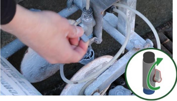
**5. Turn the valve into the upright position.** / Tournez la vanne en position verticale. / Drehen Sie nun den Ventilhebel gegen den Uhrzeigersinn in die vertikale Stellung nach oben. / Zet het grijze ventiel (vooraan) in de positie naar boven. / Drej ventilen over dysehovedet i lodret øvre position. / Vrid ventilen till upprätt läge. / Käännä venttiili ylösalaisin. /
