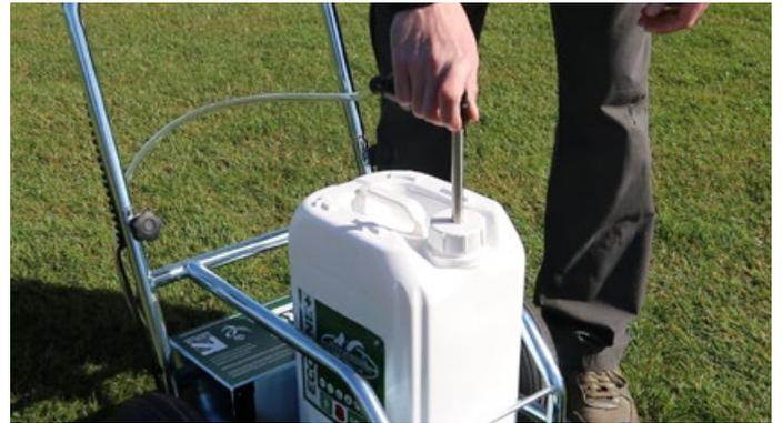
**4. Undo lid, and put probe into paint drum or tank. /** Retirez le couvercle et placez la sonde dans le pot ou le réservoir de peinture. / Deckel abnehmen und Messfühler in Farbkanister oder -behälter tauchen. / Maak het deksel los en plaats de sonde in de verfbus of tank. / Fjern låget og kom sonden i en malertromle eller beholder. / Ta bort locket och sätt i en propp i färgtrumman eller tanken. / Irrota kansi ja aseta anturi maalipurkkiin tai säiliöön. /
